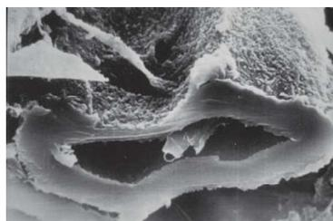
La photo ci-contre représente une coupe transversale de fibre de bouleau avec son lumen au centre et la paroi en périphérie constituée par les feuillets de macromolécules de cellulose (©C.Voillot-EFP-IRFIP)
