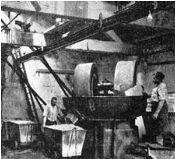
Figure 2 : meuleton utilisé pour broyer des éléments solides (écorces, grains, papier, etc.).
